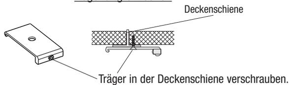
Träger in der Deckenschiene verschrauben.
