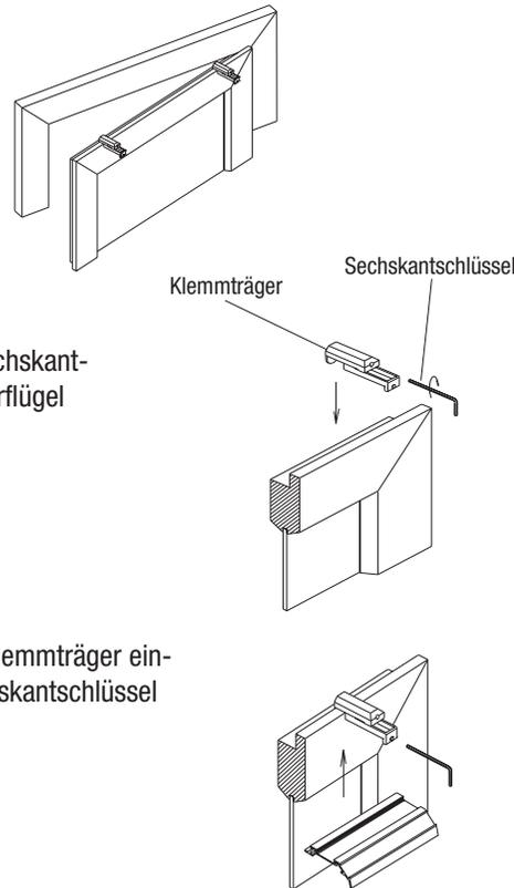
Klemmträger mit Sechskantschlüssel am Fensterflügel befestigen.
